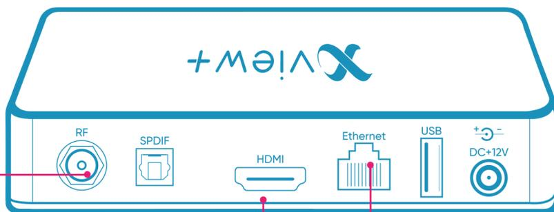
**1** Conecta tu caja al cable coaxial que viene de la red interna de tu hogar.
